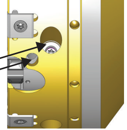
Klemmschraube für Kassette Einstellschraube
